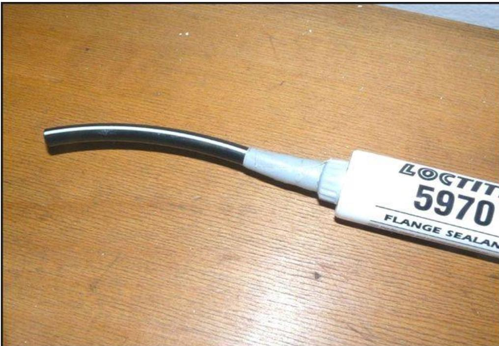
Fig. 7) L'extrémité du tube de colle est prolongée par un tube isolant (exemple)
