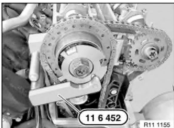
Déposer l'outil spécial 11 6 452 vissé dans la culasse de gauche (cylindres 5 à 8).
