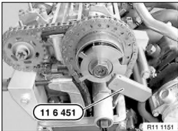
Déposer l'outil spécial 11 6 451 vissé dans la culasse de droite (cylindres 1 à 4).
